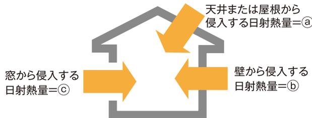
$$\frac{\text{日射熱取得量の合計 (①+②+③)}}{\text{外皮面積の合計}} \times 100 = \text{冷房期の平均日射熱取得率 (}\eta_{AC}\text{)}$$
